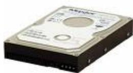
Tra i vari tipi di dispositivi di I/O più importanti sono senza dubbio gli **Hard Disk: o Disco Fisso**. La memorizzazione dei dati su disco è una delle operazioni di I/O più importanti. I dischi costituiscono il supporto sul quale vengono memorizzati i dati quando non si trovano nella memoria del computer. I dati possono essere registrati anche in
