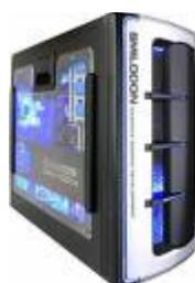
I computer a cassa verticale sono detti **Tower Computer**. Ne esistono più o meno tre misure principali: Minitower, Midtower e Fulltower (o Bigtower). La figura a lato rappresenta un minitower; il fulltower è alto circa il doppio ed è, ovviamente, in grado di contenere un maggior numero di dispositivi al suo interno.
