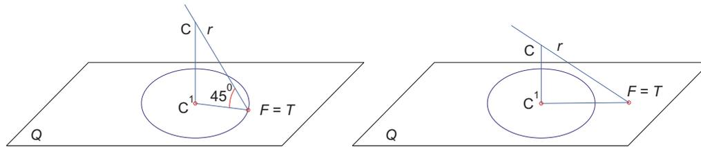
se la retta è perpendicolare al quadro e contiene il centro di proiezione, la traccia e il punto di fuga coincidono con la proiezione del centro di proiezione
