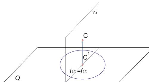
se il piano  $\alpha$  è normale al quadro e non contiene il centro di proiezione, la sua retta di fuga contiene la proiezione del centro di proiezione e risulta parallela alla traccia di  $\alpha$
