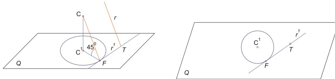
se una retta è inclinata di  $45^\circ$  rispetto al quadro e passa per il centro di proiezione, si ha che il punto di fuga e la traccia coincidono e cadono sul cerchio di distanza
