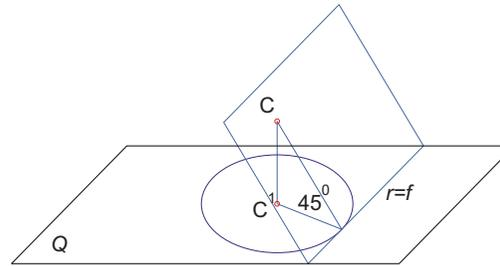
se il piano  $\alpha$  è inclinato di  $45^\circ$  col quadro, ma non contiene il centro di proiezione, la sua retta di fuga è sempre tangente al cerchio di distanza e risulta parallela a  $t$
