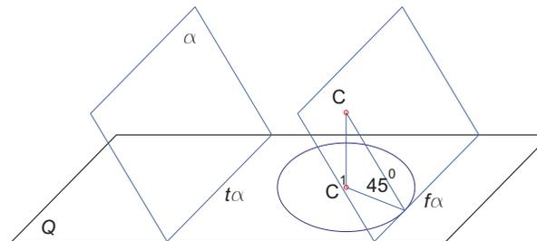
se il piano  $\alpha$  è normale al quadro e contiene il centro di proiezione, la sua traccia e la sua retta di fuga coincidono e contengono la proiezione del centro di proiezione
